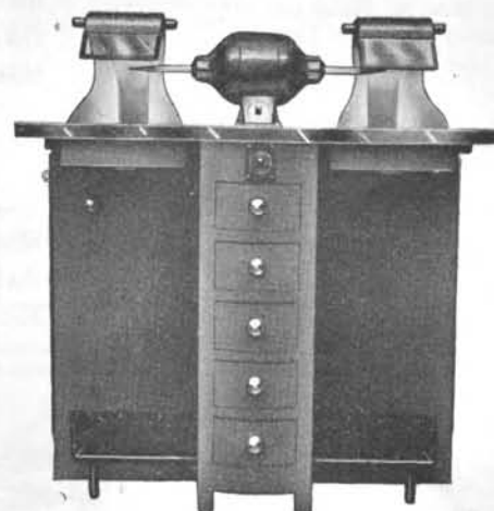
Banchi con pulitrici, aspiratore e filtri per il recupero del pulimento
