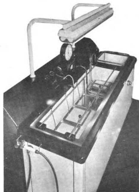
Apparato funzionante con Ultrasuoni per il lavaggio e la pulitura in massa con sostanze Alcaline. Di minuterie metalliche di qualsiasi genere. Celluloide e materiale plastico. In pochi secondi toglie e rende pulito dalle sostanze più insistenti anche nelle profondità.
