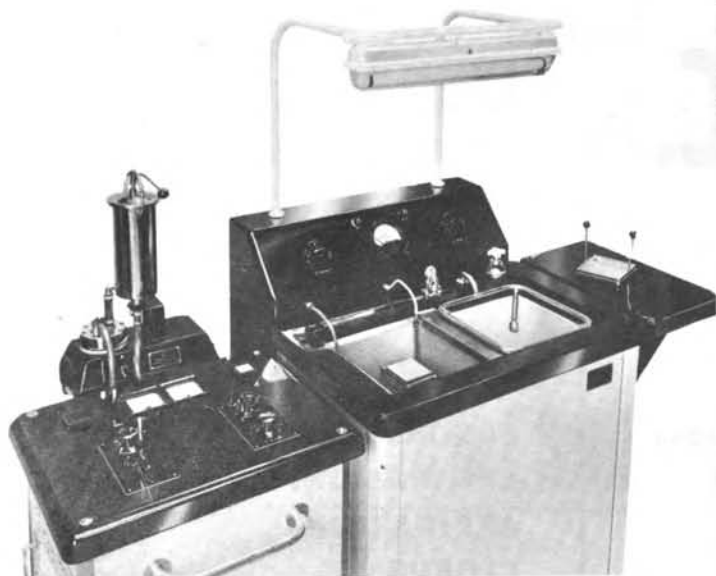
Apparato per il lavaggio - sgrassaggio e pulitura con Ultrasuoni di minuterie in massa, metalli di qualsiasi natura, materie plastiche, celluloide, ecc. La pasta viene perfettamente asportata anche dalle cavità in pochi secondi senza alterare la brillantezza degli aspetti. Le gioiellerie, dopo lo sgrassaggio o lavaggio finale, rimangono perfettamente brillanti e senza alcuna macchia. Questi apparati esistono in diverse grandezze.
