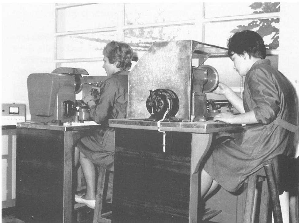
*Le due dipendenti della fabbrica fratelli Doria addette alle operazioni di lapidatura. Si notino: il particolare morsetto che trattiene i pezzetti di oro da lapidare; la lapidatrice a destra che sta ponendo sul disco rotante l'apposito abrasivo.*
