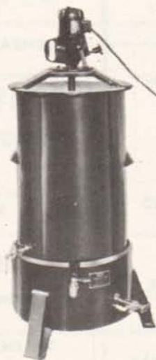
Apparato per il recupero dell'oro dai bagni vecchi o mal riusciti, dando la possibilità di recuperare totalmente l'oro od altri metalli preziosi esistenti nei bagni, lavoro eseguito con la massima facilità e la minima spesa.
