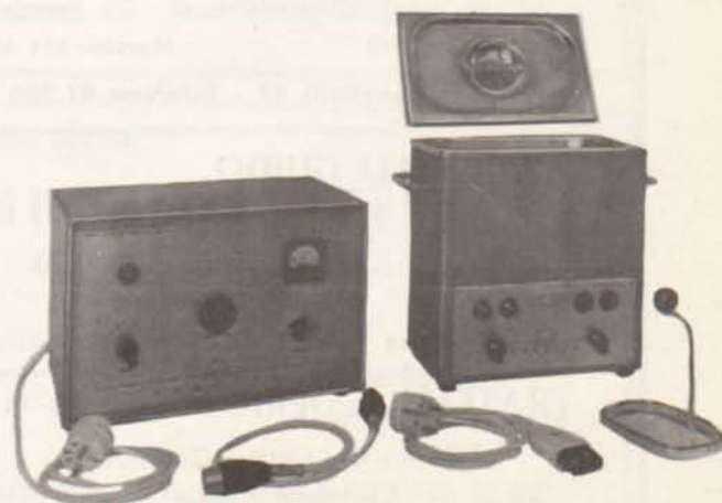
Apparato Microm a Ultrasuoni alla portata di tutte le piccole industrie per il lavaggio - sgrassaggio di minuterie (gioiellerie, orologerie, parti meccaniche, apparati elettrici ecc.). Non dà odori. Innocuo sotto ogni aspetto. Non dà luogo a corrosioni.
