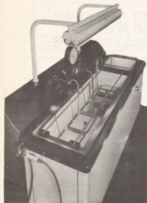
Apparato funzionante con Ultrasuoni per il lavaggio e la pulitura in massa con sostanze Alcaline. Di minuterie metalliche di qualsiasi genere. Celluloide e materiale plastico. In pochi secondi taglia e rende pulito dalle sostanze più insistenti anche nelle profondità.
