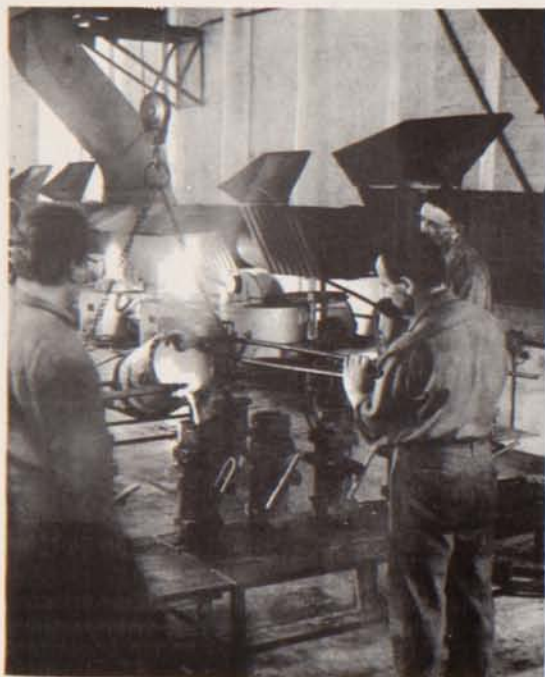
La colata dell'argento 800‰. Una numerosa serie di forni alimenta in continuazione il procedimento.
